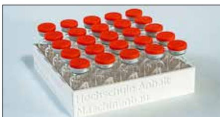
Damit Impfpullen innerhalb des Impfzentrums sicher transportiert werden können, braucht es geeignete Transportbehälter. Da im Impfzentrum des Landkreises Anhalt-Bitterfeld bislang zu wenige vorhanden waren, sprang der Fachbereich Elektrotechnik, Maschinenbau und Wirtschaftsingenieurwesen der Hochschule Anhalt kurzum ein und entwickelte über seine 3D-Druckerwerkstatt innerhalb einer Woche vier neue funktionstüchtige Behälter.
